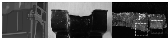
(a)零件装配位置 (b)零件失效形貌 (c)裂纹源形貌
