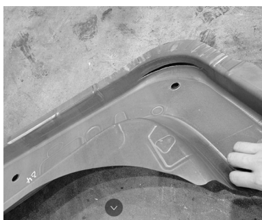
图3 某车型A柱内板转角开裂示意
