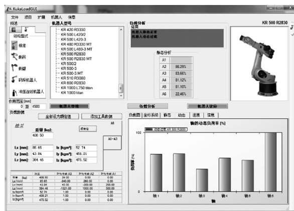
图3 机器人动态负载计算超载界面
