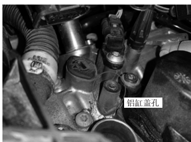
(a)点火线圈固定螺栓的装配位置
