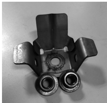
图2 右边的螺母法兰盘被加热变深色
