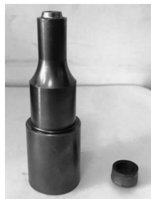
图15 预应力冲孔冲头与冲豆
