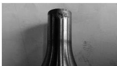
图14 小间隙冲裁26孔后冲头
