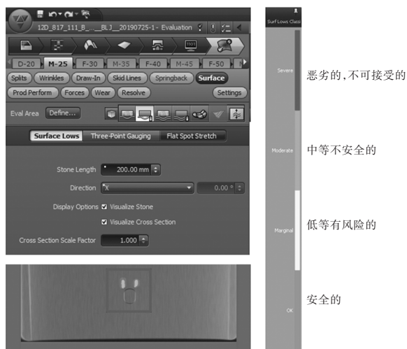
图 11 拉伸模拟后油石检查状态
