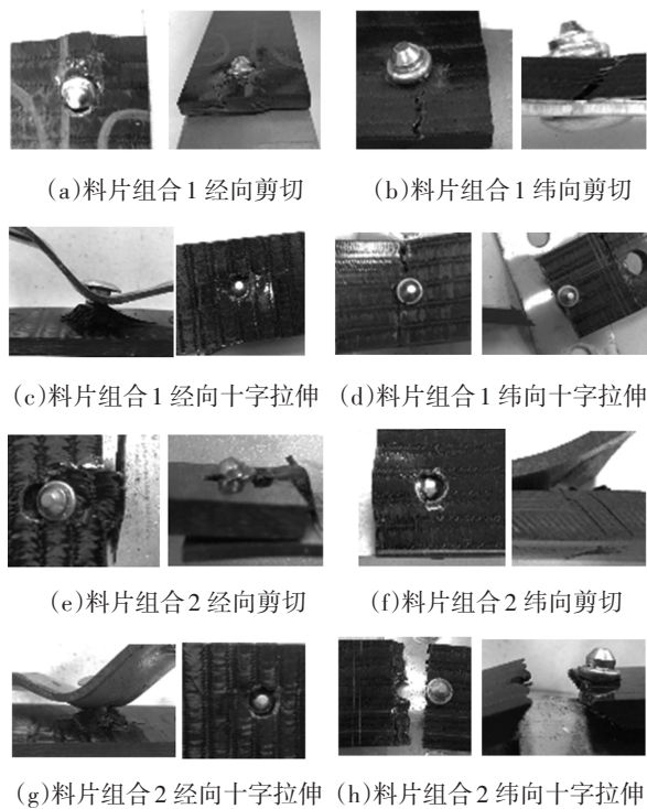
图7 各试件静力学试验破坏形貌
