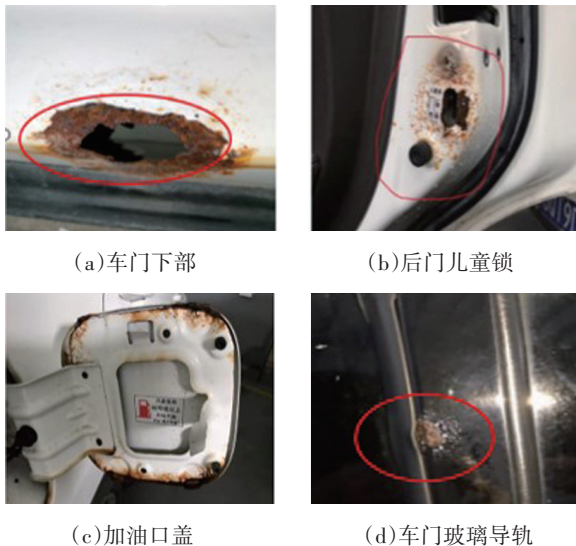
图 8 汕头滨岸地区某车型车身锈蚀
