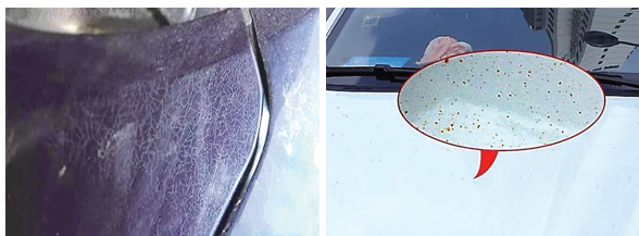
图9 酸雨对汽车漆面和基材的腐蚀破坏
