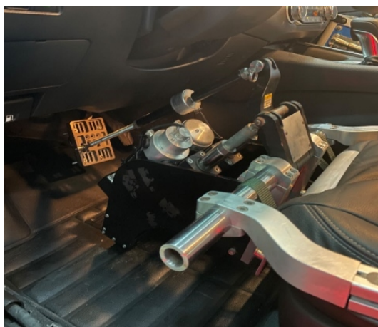
图1 试验制动机器人及数采布置
