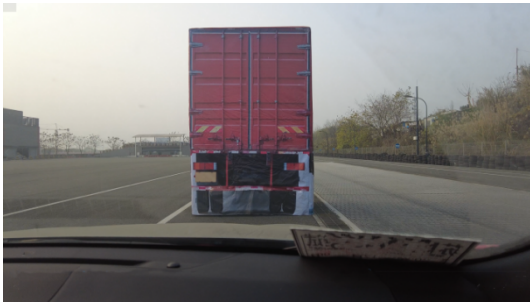
图16 乘用车追尾卡车AEB测试
