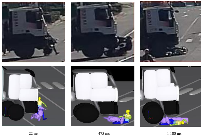
图7 事故中两轮车及其骑行者运动学响应对比
