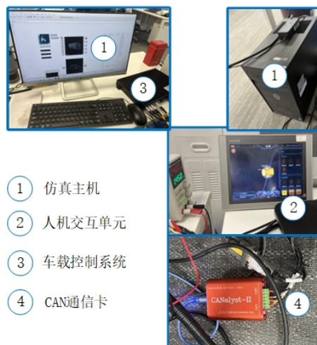
图13 HIL 仿真测试平台
