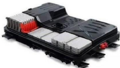
日产Leaf“凹”形电池包（车身底部悬置式）
