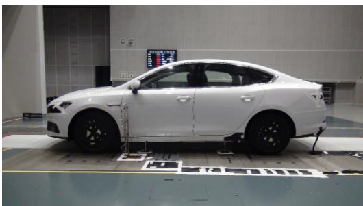
图5 秦Pro-EV在丰田新风洞中进行测试
