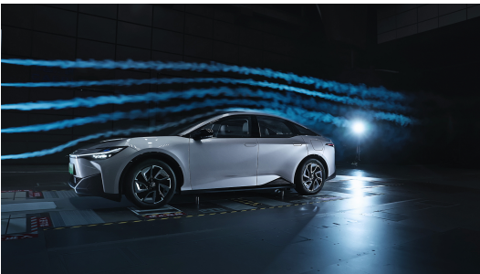
图 31 bZ3 样车风洞测试
