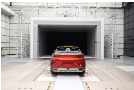
图7 实车风洞试验
