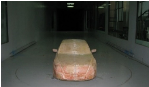
图 5 1:3 模型风洞试验
