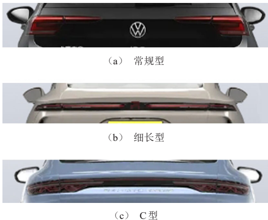
图5 三种电动汽车尾灯
