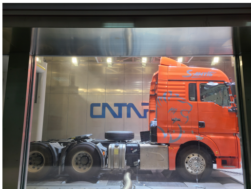
图 12 整车环境风洞测试
