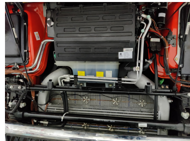
(c) 冷却模块风速及温度布点
