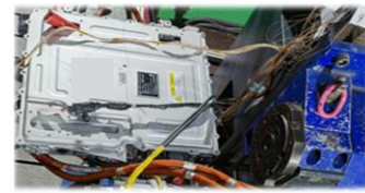
(a) 电机控制器台架试验
