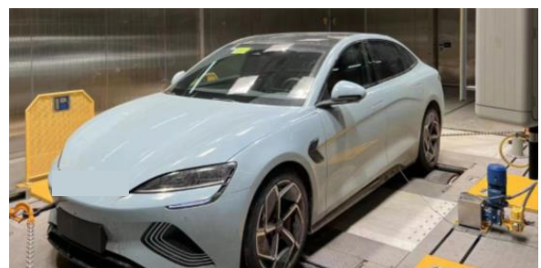
图 4 整车热管理系统台架试验
