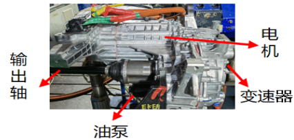
(b) 电驱动系统台架试验
