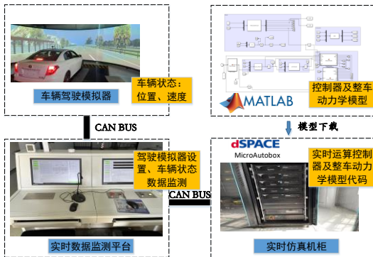
图 16 无人车路径跟踪硬件在环测试方案
