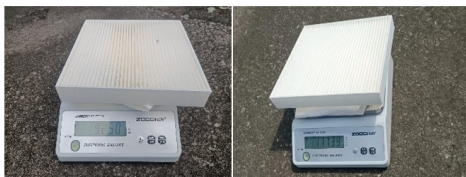
图 8 基础状态空调进水量(吸水棉试验前/后质量差)
