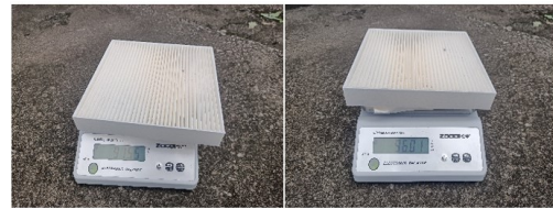
图 18 优化状态空调进水量（吸水棉试验前/后质量差）
