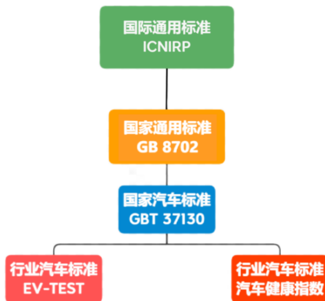
图6 我国电动汽车电磁辐射标准体系框架
