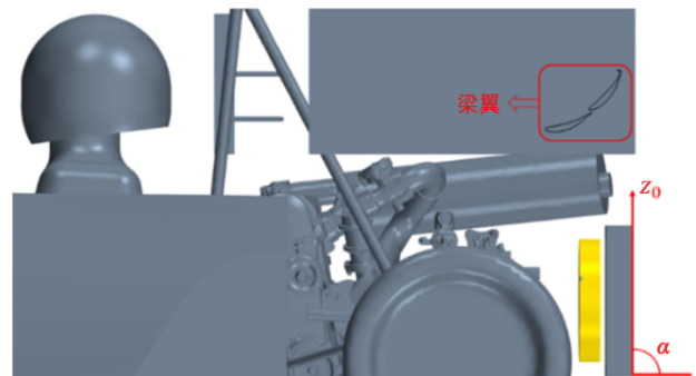
图 14 散热装置位置变量选取示意图
