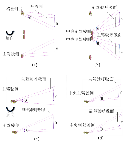
图 9 出风口叶片旋转角度范围
