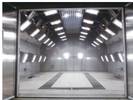
图5 弧形灯架及侧边辐照灯设计
