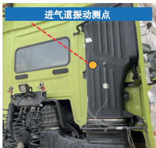
图8 低阻进气系统进气道总成模态测试
