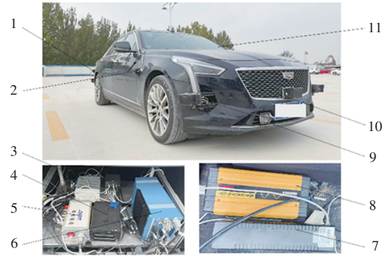
1. 高清摄像头 2. 功能摄像头 3. 传感器控制器 4. NAS 设备 5. 电源盒 6. 工控机 7. 稳压电源 8. 逆变器 9. 毫米波雷达 10. 激光雷达 11. DMS 摄像头
