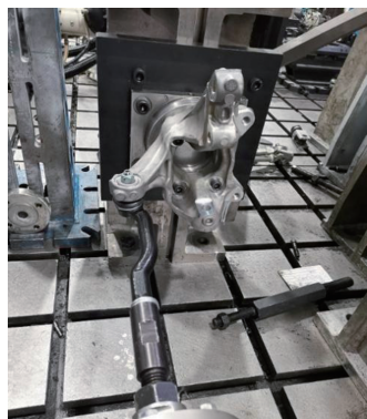
图10 转向节节臂疲劳试验台架
