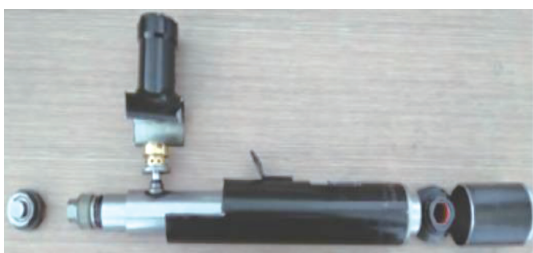
图1 CDC减振器实物拆解
