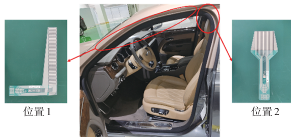
图4 密封条动态压痕测试位置
