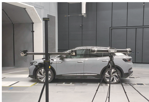
图6 高速行驶工况车门外张变形量测试
