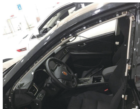
图11 车身与车门内间隙测试
