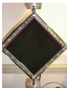
(a)面套剪切试验
