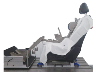
图 8 H 点位置的检测试验
