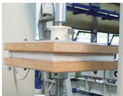
图2 发泡力学特性测试
