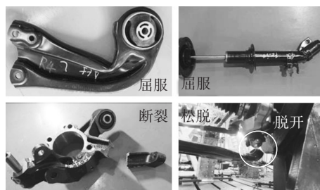
图6 悬架系统极限强度试验常见失效模式
