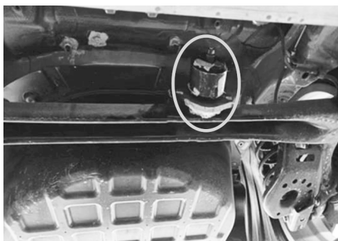
图6 后扭力梁增加80 Hz吸振器方案
