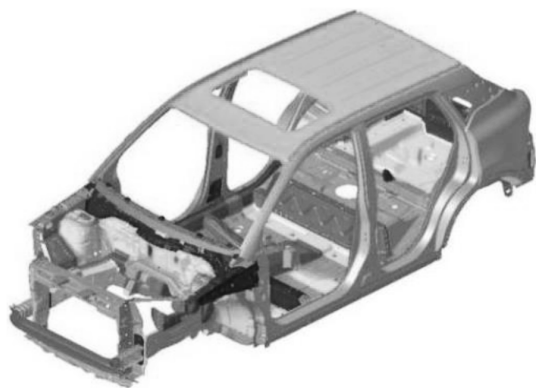
图1 白车身的正面碰撞仿真分析模型
