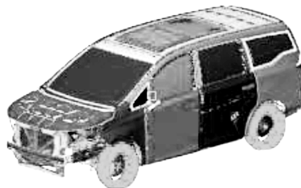
图4 某车辆整车有限元模型
