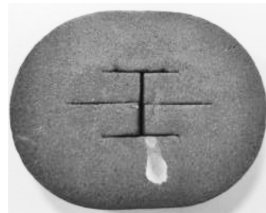
(a)压缩前的定位销泡沫垫块
