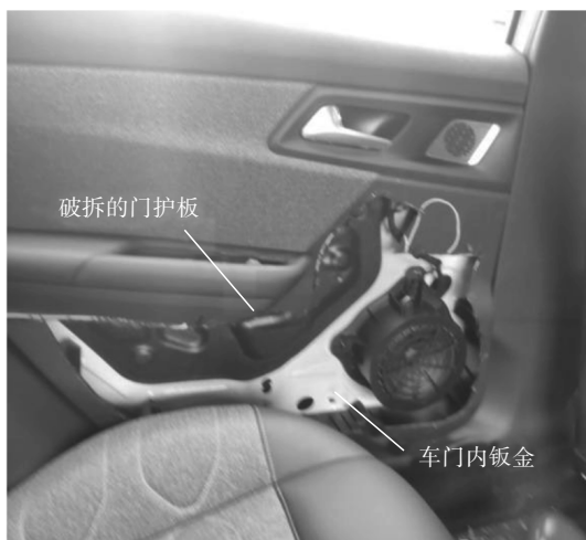
图14 破拆门护板淋雨检查
