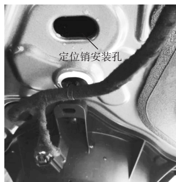
(b)水从钣金孔表面流到扬声器表面
