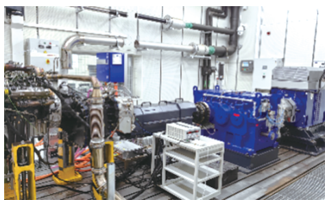
图7 混联式动力系统试验台架
