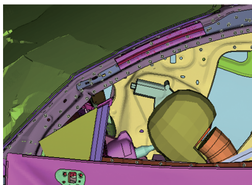
图8 配置双叉臂前悬架时A柱折弯仿真结果
