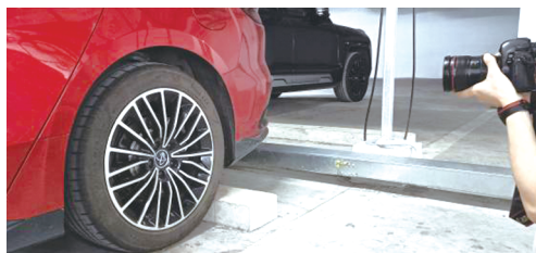
图3 车辆轮眉图像拍摄示意
