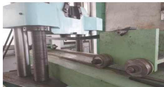
图2 板簧力学特性试验平台和测试过程
