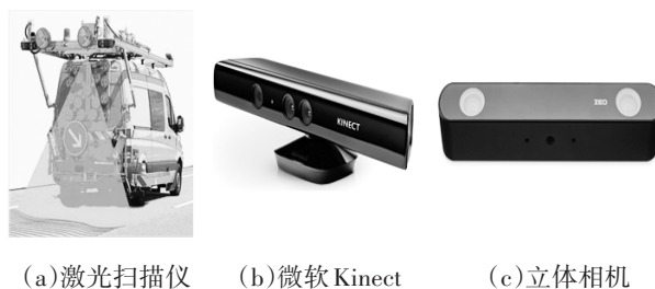
图2 三维道路数据采集传感器
