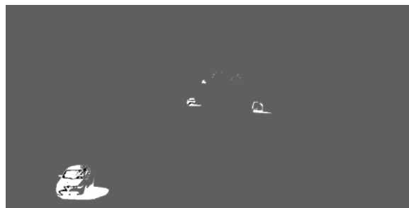
图5 读取视频、灰度化、高斯去噪、去背景后的结果
