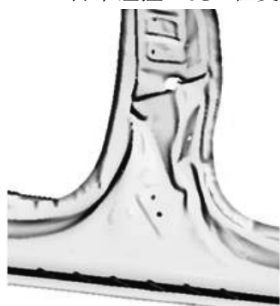
(c) SC-MDB 台车碰撞工况 B 柱变形情况
