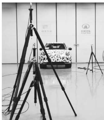
图8 喇叭近场响应声压测试现场
