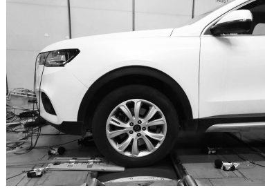
图7 轮胎前、后沿声源到麦克风传递函数测试现场
