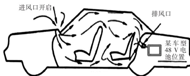
图15 外循环模式下乘员舱内空气流动示意
