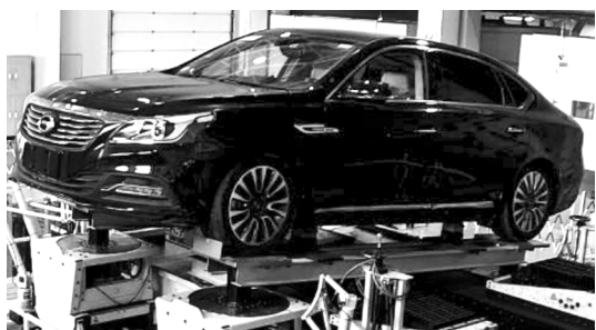
图2 整车重心高度测量试验
