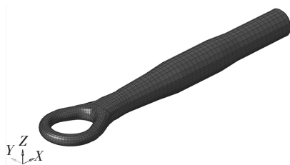
图2 牵引装置有限元模型
