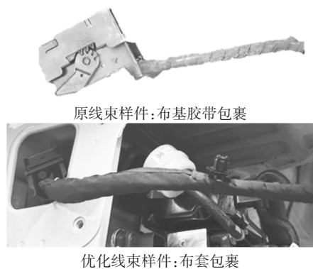
(a)电源线束包裹材料优化样件效果验证
